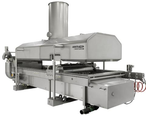
FOODesign batch-pro<sup>®</sup> 12 可间歇式地油炸多种果蔬片，包括薯片、芋头片、香蕉片和芭蕉片。FOODesign batch-pro<sup>®</sup> 12 拥有高效的蛇形热交换器管道配置，可提供效率更高、运行成本更低的直火加热。油炸机的先进系统还设计了高速三段式油渣过滤功能，有助于延长油的使用时长，保持产品的一致性。含双侧驱动自动搅拌器，可消除不畅因素，避免对传输系统造成损坏。
