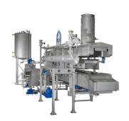
Florigo conti-pro® PC 3 是一款创新的连续式薯片油炸系统,拥有取得专利的 opti-flow® 技术。Opti-flow® 可优化油流和产品流,使您的产品保持高水平的质量。99% 的旋风死点是在油炸程序开始时消除的,确保将产品流的拒识率降至 2-3% 以下。Florigo conti-pro® PC 3 拥有多流向注油系统和自动温控功能,令您能够完全控制油炸工艺,使薯片纹理和质量始终保持一致。
