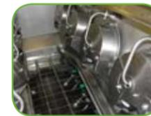
旋转盘技术借助 360° 喷射进行涂覆控制，从而传送机上的产品得到均匀涂覆。旋转盘适用于中高涂覆速率，易于使用，无接触保证卫生，可靠性无以伦比
